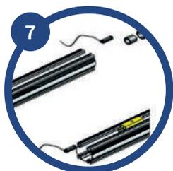
Coloque os reed's na canaleta do automatizador, parafuse o limitador mecânico. Para instalação eletrônica consulte a seção centrais de comando.
