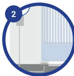
Providencie um ponto de energia, passando um conduíte, partindo do automatizador até o quadro com um disjuntor unipolar/bipolar de 10A.
