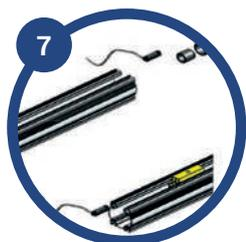
7 Coloque las lengüetas en el canal del automatizador, atornille el limitador mecánico. Para la instalación electrónica, consulte la sección Centros de control.
