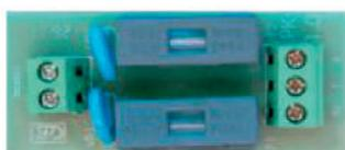
*Placa de protección contra sobretensiones. En caso de un cambio repentino en la red eléctrica, los componentes se rompen, evitando que la sobrecarga quemara el panel de control. Encienda su placa PK antes que el panel de comando usando la salida de red.*
