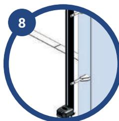
8 Acerque los sensores a la tuerca de automatización. Realice la conexión eléctrica del panel, conecte los sensores de fin de curso.
